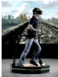
شكل (18) يوضح جهاز الثبات والحركة أحد أدوات الإبحار في بيئة الواقع الافتراضي
