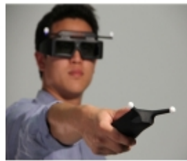
شكل (17) يوضح العصا وأدوات التحكم البسيطة السلكية واللاسلكية المستخدمة في التفاعل
