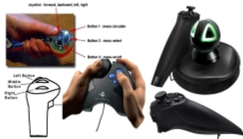
شكل (17) يوضح العصا وأدوات التحكم البسيطة السلكية واللاسلكية المستخدمة في التفاعل
